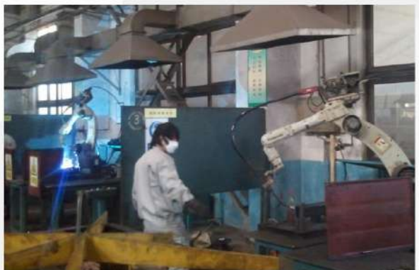
Officina di saldatura (attrezzatura di saldatura robotica Panasonic importata)
